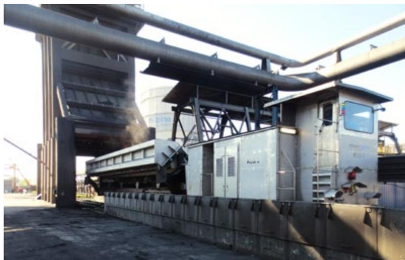
*Die Kokslöschgarnitur bestehend aus Kokslöschlokomotive und Kokslöschwagen*
