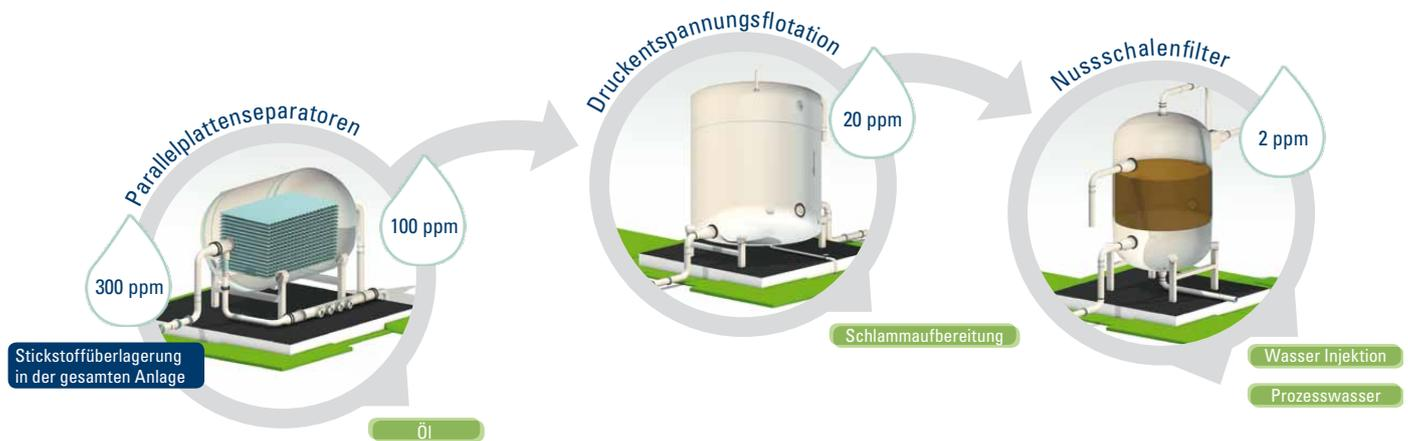
Die neue Wasseraufbereitung ersetzt die alte Wasserflut-anlage und benötigt hierbei nur ein Fünftel der Anlagen-grundfläche. Das geschlossene Anlagensystem reduziert die CO2 Emissionen um 70%. Des Weiteren ist die Anlage so weit automatisiert, dass ein mann-loser Betrieb mit einer Anla-genverfügbarkeit von 99,9%
