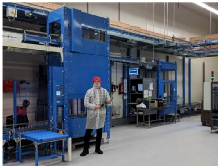
Unser Kunde ist ein Hersteller von Tiefkühlbackwaren v.a. für die Gastronomie und Hotellerie. Eine der Verpackungsanlagen wurde um eine Leerkarton-Strecke erweitert und die bestehende Befüllung der Kartons versetzt bzw. angepasst.
