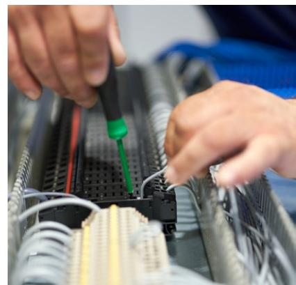
Jeder Schaltschrank unterläuft während der Produktion mehrfache Prüfungen – von der Bestückung, Beschriftung über die Verdrahtung bis zur abschließenden fachgerechten Endkontrolle nach den aktuell gültigen einschlägigen Normen, Vorgaben und Richtlinien.
